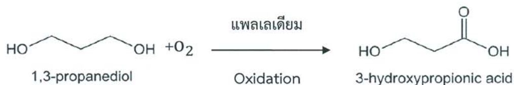
ภาพที่ 2.4 กระบวนการออกซิเดชัน 1, 3-propanediol ที่มีแพลเลเดียมเป็นตัวเร่งปฏิกิริยาในการผลิต 3-hydroxypropionic acid
