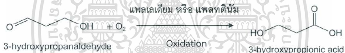
ภาพที่ 2.5 กระบวนการออกซิเดชันของ 3-hydroxypropionaldehyde ที่มีแพลเลเดียมหรือแพลทตินัมเป็นตัวเร่งปฏิกิริยาในการผลิต 3-hydroxypropionic acid
