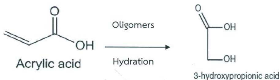
ภาพที่ 2.6 กระบวนการไฮเดรชัน acrylic acid โดยใช้กรดเป็นตัวเร่งปฏิกิริยา
