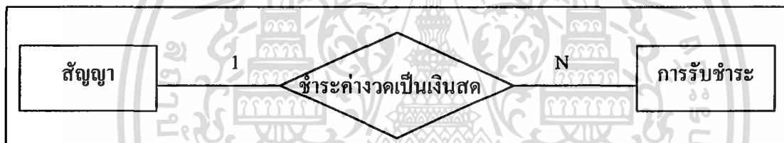
ภาพที่ 12 แผนภาพโมเดล E-R แสดงความสัมพันธ์ระหว่างเอนทิตีสัญญากับการรับชำระ
