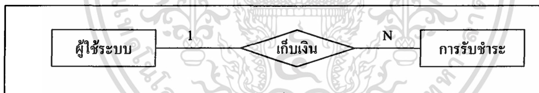
ภาพที่ 15 แผนภาพโมเดล E-R แสดงความสัมพันธ์ระหว่างเอนทิตีผู้ใช้ระบบกับการรับชำระ
