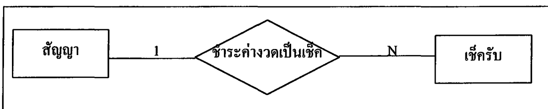
ภาพที่ 13 แผนภาพโมเดล E-R แสดงความสัมพันธ์ระหว่างเอนทิตีสัญญากับเช็ครับ
