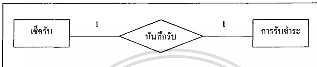
ภาพที่ 14 แผนภาพโมเดล E-R แสดงความสัมพันธ์ระหว่างเอนทิตีเช็กรับกับการรับชำระ
