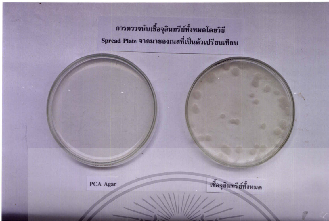
ภาพที่ 7 การตรวจนับโดยวิธี spread plate หาเชื้อ จุลินทรีย์ทั่วไป ในอาหาร PCA agar
