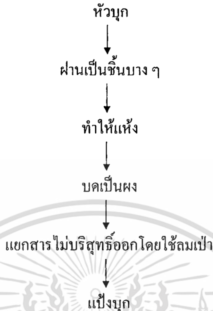
ภาพที่ 1 กระบวนการผลิตแป้งบุกแบบแห้ง (dry method)
