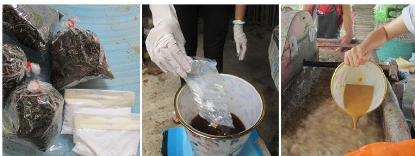
ภาพที่ 3 แสดงขั้นตอนการผสมสารนาโนไทเทเนียมไดออกไซด์
