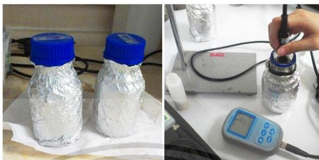
ภาพที่ 31 แสดงการวัดค่าในน้ำที่ผลิตกระดาษสา
