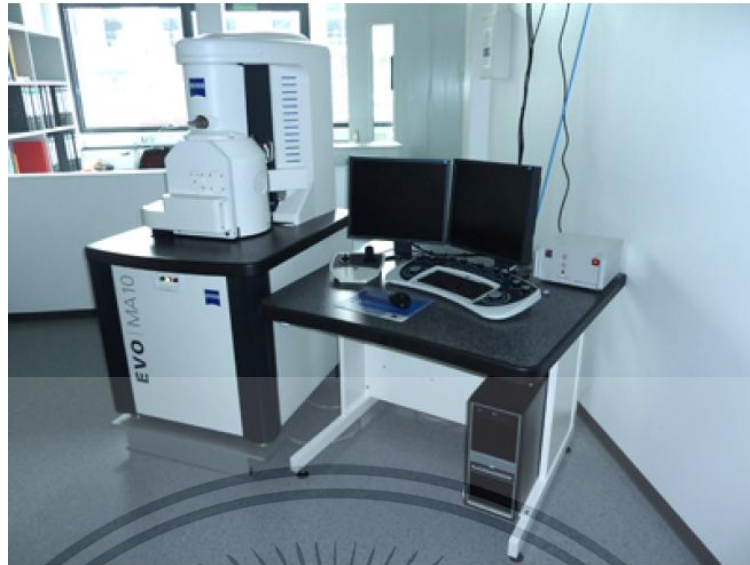
รูปที่ ค.2 กล้องจุลทรรศน์อิเล็กตรอนแบบส่องกราดยี่ห้อ ZEISS รุ่น MA10
