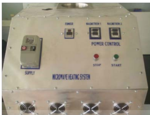
รูปที่ 3.5 เครื่องไมโครเวฟที่ดัดแปลงเพื่อเพิ่มกำลังวัตต์สูงสุดเป็น 1600 W
