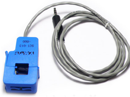
Figure 5.5: YHDC SCT013 module
