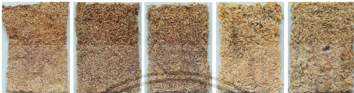
ภาพภาคผนวก ค.1.1 กระดาษที่ไม่ผ่านการการแช่น้ำ แต่ไม่ผ่านการต้มเยื่อด้วยสารเคมี (NS-NC)
