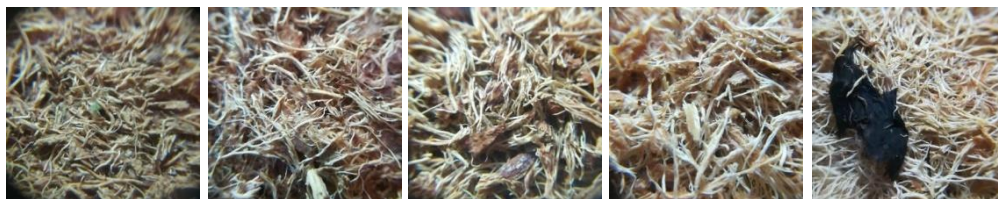
ภาพภาคผนวก ค.2.1 เส้นใยที่ไม่ผ่านการแช่น้ำ ไม่ผ่านกระบวนการสกัดทางเคมี (NS-NC)
