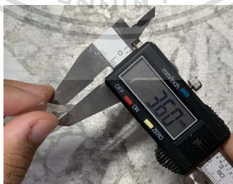
ภาพที่ 3.1 เครื่อง Vernier Caliper แบบดิจิตอล
