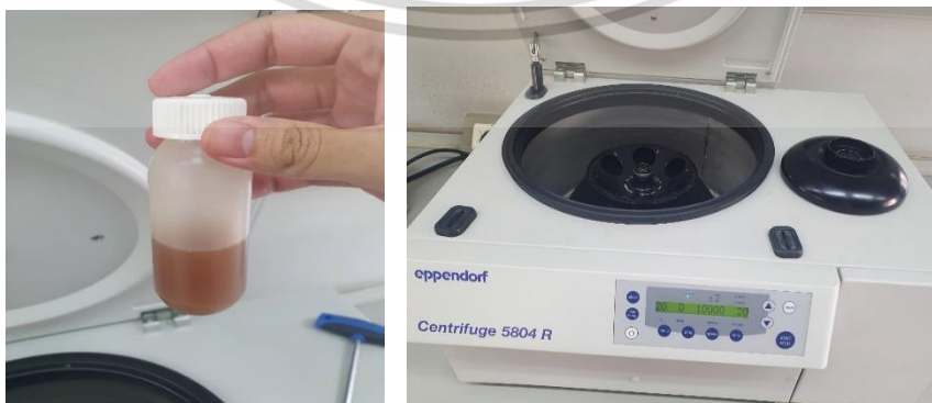
ภาพที่ 3.9 เหวี่ยงแบบควบคุมอุณหภูมิ (Eppendorf 5804 Centrifuge)
