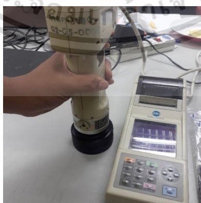
ภาพที่ 3.2 วัดค่าสีเครื่องวัดสี Minolta CR-400
