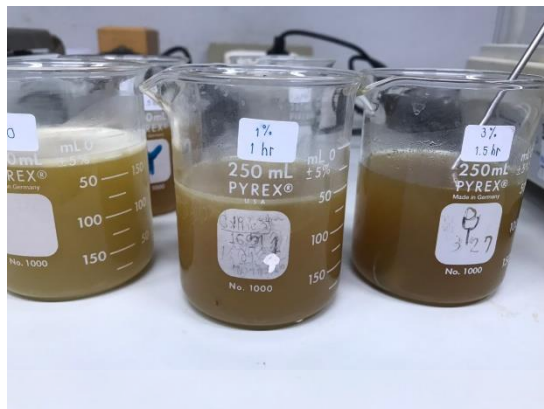
รูปที่ ก.6 สารละลายโปรตีนไฮโดรไลเซทส่วนใสจากการหมუნเหวียง
