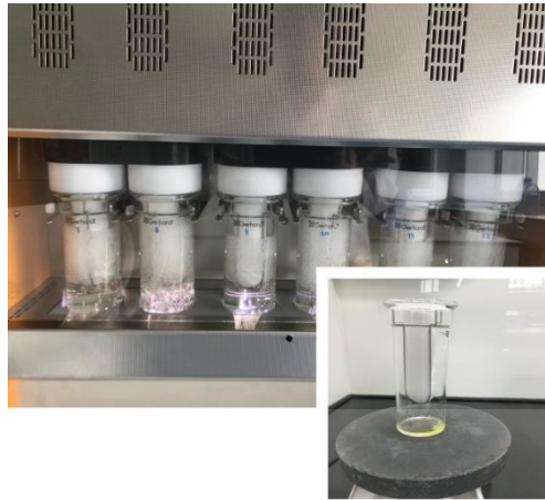
รูปที่ ข9. อุปกรณ์ชุดสกัดไขมัน (Soxhlet apparatus) ที่มา: บันทึกภาพจากห้องปฏิบัติการคณะอุตสาหกรรมอาหาร
