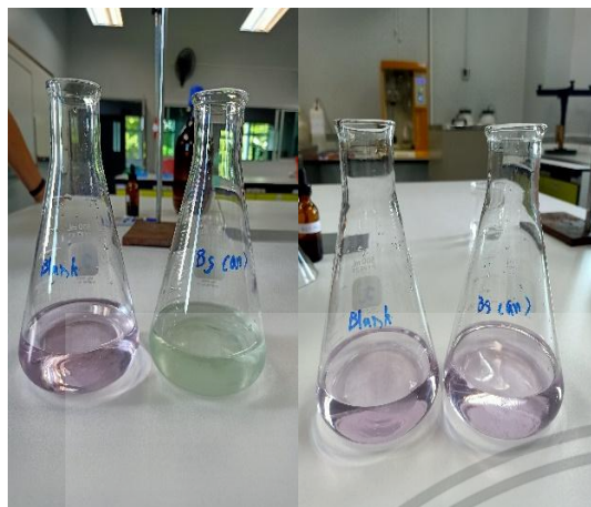
ภาพที่ ง.13 ตัวอย่างลักษณะการไตเตรทของการวิเคราะห์โปรตีนของเชื้อ B. subtilis TISR001 ในสภาวะไม่มีอากาศ
