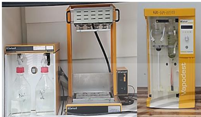
ภาพที่ ข.15 ชุดกลั่นและย่อยไนโตรเจน (เครื่องย่อยไนโตรเจน) (Kjeldahl)
