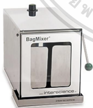
ภาพที่ ข.13 เครื่องตีบดละเอียด (Stomacher)
