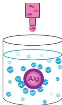
รูปที่ 2.1 การเกิดเจลของเม็ดปิดส์โดยใช้เทคนิคการขึ้นรูปทรงกลมพื้นฐาน (basic Spherification)
