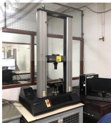
รูปที่ 3.2 เครื่องทดสอบยูนิเวอร์แซล
