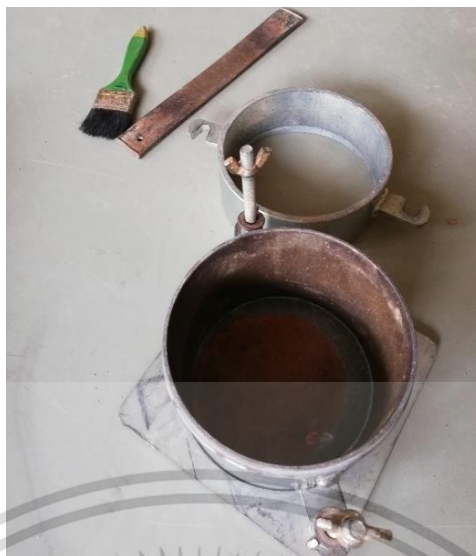
รูปที่ 3.13 แสดงวัสดุและอุปกรณ์การทดสอบการบดอัดดิน
