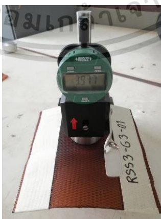
รูปที่ 3.4 แสดงการวัดความหนาของแผ่นยาง
