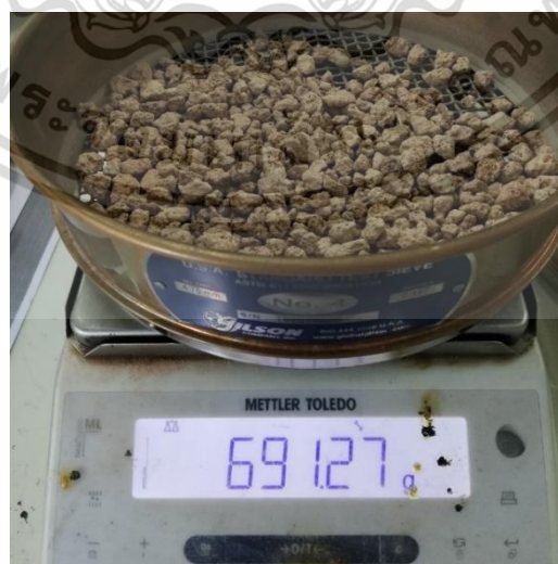
รูปที่ 3.12 แสดงการชั่งน้ำหนักตะแกรงที่มีดินค้างอยู่
