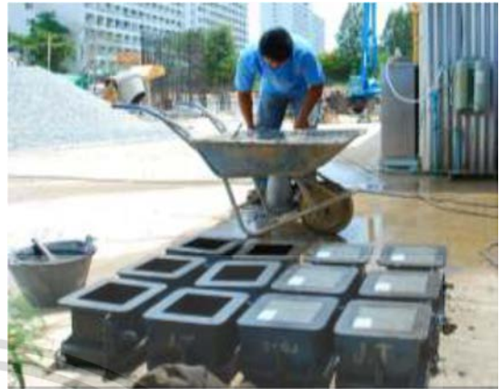
รูปที่ 2.64 การเช็ค Slump คอนกรีตก่อน รูปที่ 2.65 การเก็บตัวอย่างคอนกรีตหน้างาน อนุญาตให้เทลงในแบบหล่อ
