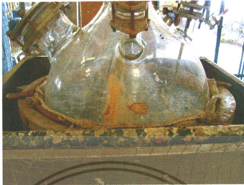
รูปที่ ก.6 เครื่องต้มระเหยเรเออร์ทคลอไรด์ผสม
