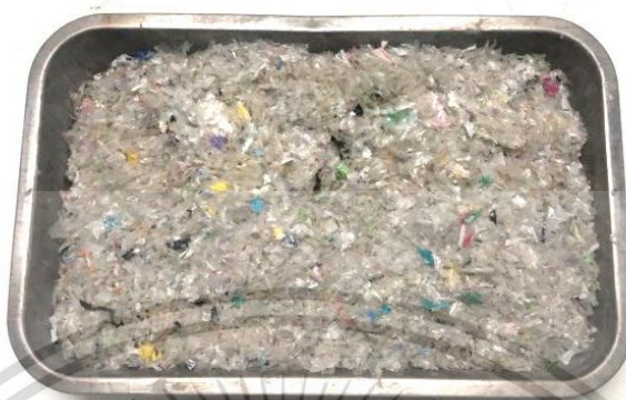
รูปที่ 3.6 ชิ้นพลาสติกตัวอย่างที่จะนำมาวัดขนาด
