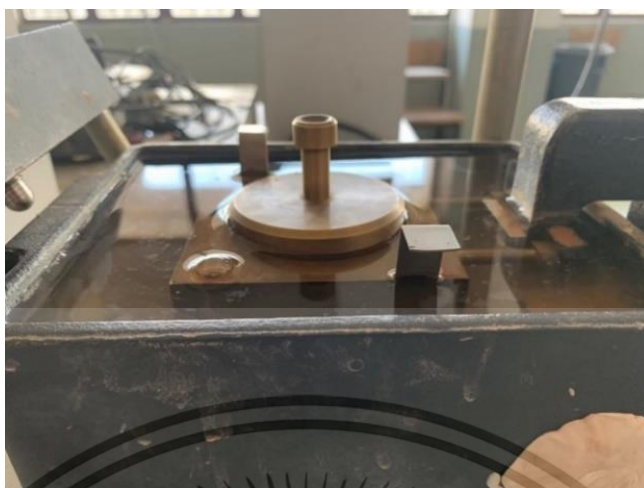
รูปที่ 3.14 รูปทำการ Saturated ให้ดินอยู่ในสภาวะอิ่มตัวด้วยน้ำ
