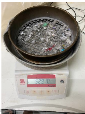
รูปที่ 3.3 รูปชั่งพลาสติกที่ค้างอยู่บนตะแกรง
