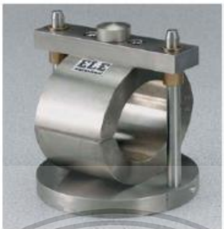
รูปที่ 3.10 ชุดวงแหวนรับแรง (Ring Dynamometer Assembly)
