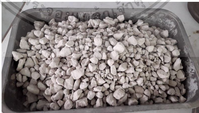
รูปที่ 3.2 เศษคอนกรีตมวลเบาที่ใช้เป็นมวลรวมหยาบ
