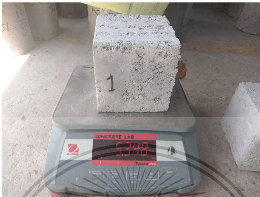
รูปที่ ก.7 การชั่งน้ำหนักตัวอย่างคอนกรีตบล็อก
