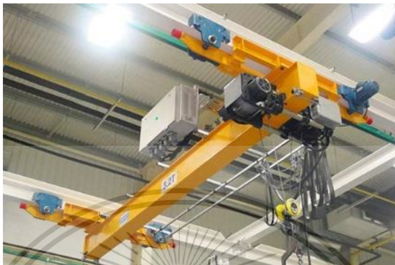
รูปที่ 2.3 ปันจันเหนือศีรษะแบบคานเดี่ยว (Overhead crane), (P&P Steel (Thailand), http://pandpsteelthailand.thailandpages.com/category/%E0%B9%80%E0%B8%84%E0%B8%A3%E0%B8%99-100002837/ )
