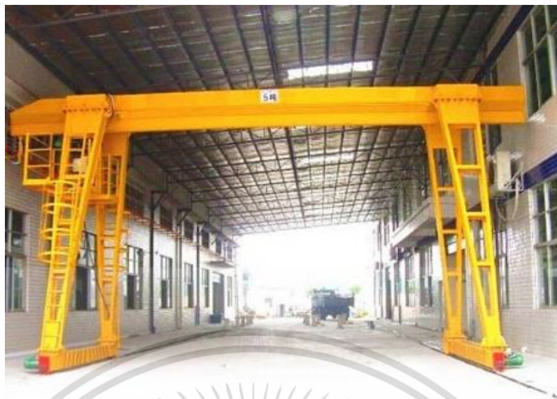
รูปที่ 2.4 ปั่นจั่นขาสูง (Gantry crane) , (P&P Steel (Thailand),
