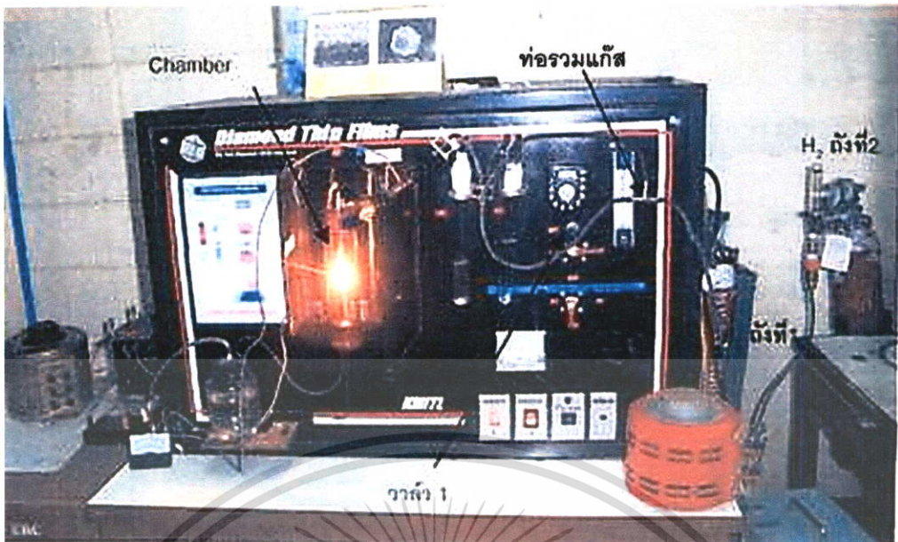
รูปที่ 4.1 ชุดอุปกรณ์การทดลองที่ใช้ในการสังเคราะห์คาร์บอนนาโนทิวป์
