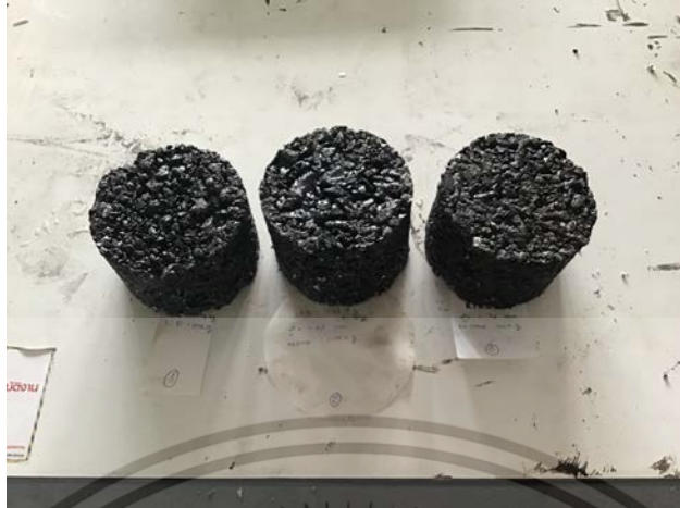
รูปที่ 3.8 ตัวอย่างของส่วนผสมพอร์สแอสฟัลท์ที่ถูกบดอัด
