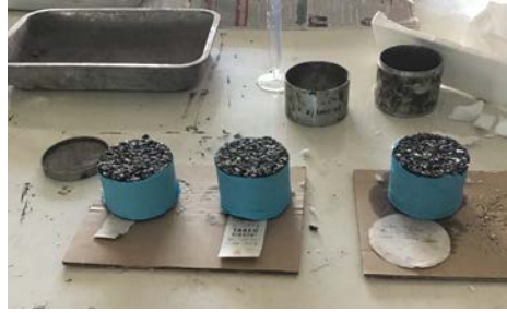
รูปที่ 3.10 แสดงการจำลอง และ สมการที่ใช้ ในการทดลองหาค่าความชื้นผ่านของน้ำ
