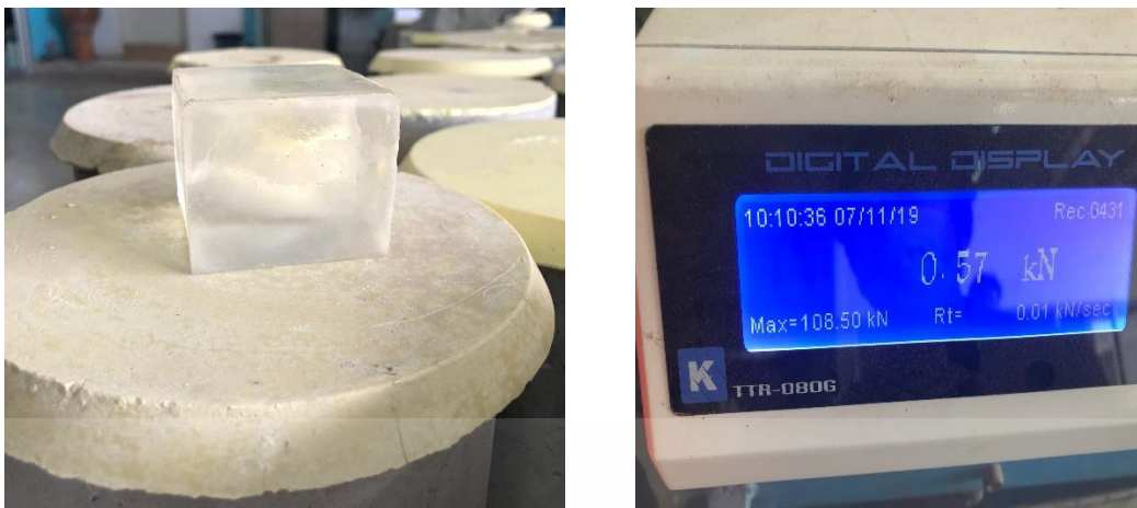
รูปที่ 4.1 ผลการทดสอบรับแรงอัดของอีพอกซี
