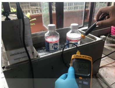
รูปที่ 3.11 การปรับอุณหภูมิสารในอ่างปรับอุณหภูมิ
