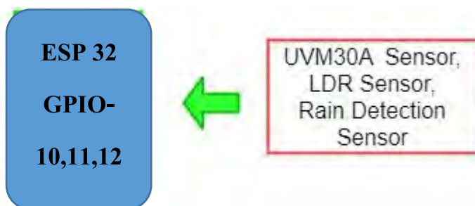
รูป 3.9 การเชื่อมต่อเซ็นเซอร์ UVM30A , LDR ,Rain Detection
