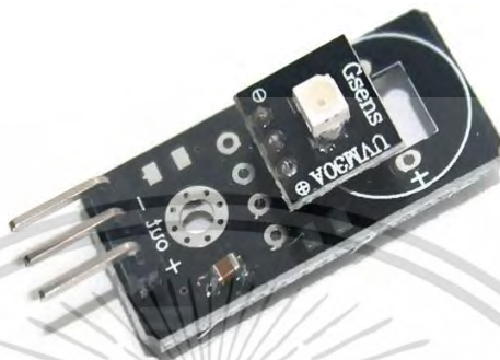
รูป 2.5 โมดูลเซนเซอร์วัดค่ารังสีอัลตราไวโอเล็ต (UVM-30A UV Sensor)
