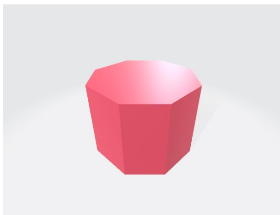
รูปที่ 3.39 ฐานรูปทรงแปดเหลี่ยมที่ใช้สำหรับวางชิ้นส่วนที่ต้องการตัดแยก
