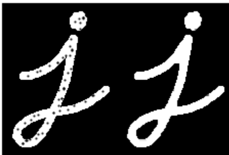
รูปที่ 2.4 การเปรียบเทียบก่อน-หลังการทำ Closing
