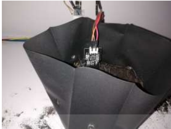
รูปที่ 3.10 การติดตั้งเซ็นเซอร์วัดความชื้นในดิน(Capacitive Analog Soil Moisture Sensor)
