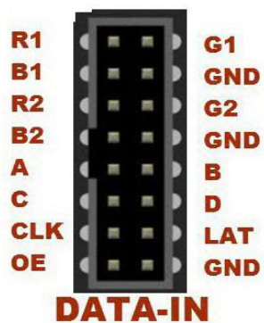
รูปที่ 3.10 รายละเอียดของ Socket Data-In
