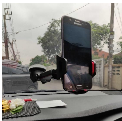
รูปที่ 3.7 ส่วนด้านหน้าเมื่อติดตั้งจริง รูปแบบใช้ Smartphone เป็นตัวประมวลผล
