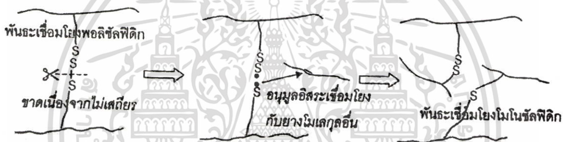
รูปที่ 2.7 ตัวอย่างกลไกการเสื่อมสภาพแบบเชื่อมโยง เปลี่ยนพันธะเชื่อมโยงพอลิซัลฟิดิกเป็นโมโนซัลฟิดิก
