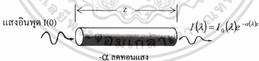
รูปที่ 2.12 การลดทอนของแสงเนื่องจากถูกวัสดุดูดกลืน
