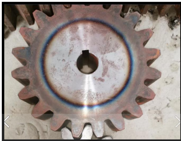
รูปที่ 3.2.8 เฟืองประกบระหว่างมอเตอร์ไฮดรอลิกกับเฟืองวงแหวน
