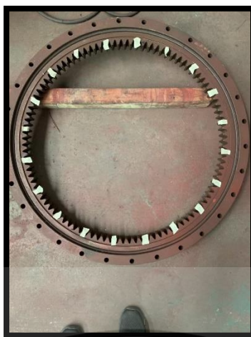
รูปที่ 3.2.3 ฟันเฟืองวงแหวน ที่เลือกนำมาใช้งาน
