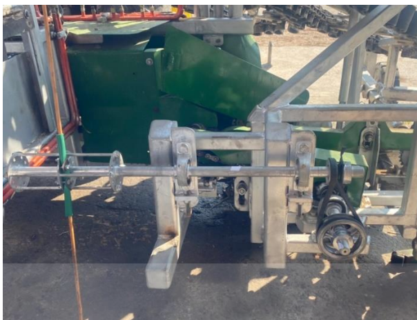
รูปที่ 55 ส่วนสางใบที่เพิ่มขึ้นด้านหลัง
