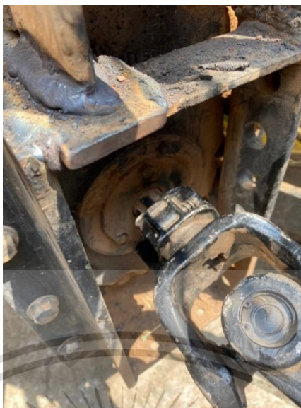
รูปที่ 51 การเชื่อมเพลาPTOกับเครื่องตัดอ้อย
