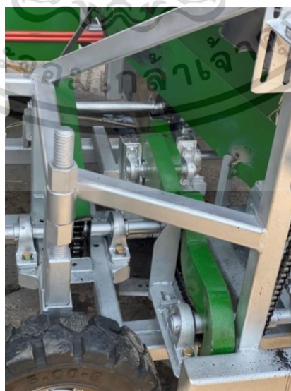
รูปที่ 54 ที่ครอบเพื่อป้องกันชิ้นส่วนต่างๆจากใบอ้อย
