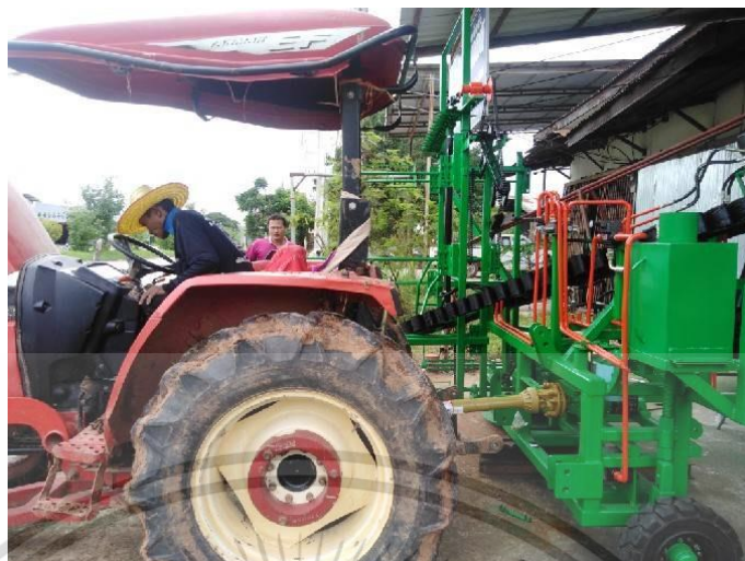
รูปที่ 39 การเชื่อมต่อรถแทรกเตอร์กับเครื่องตัดอ้อย
