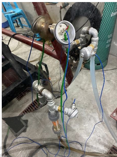
รูปที่ ซ-6 แสดงการติดตั้งเทอร์โมคัปเปิลและน้ำหล่อเย็น
