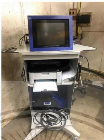
รูปที่ 3.18 เครื่องวิเคราะห์ปริมาณแก๊ส (Gas Analyzer)
