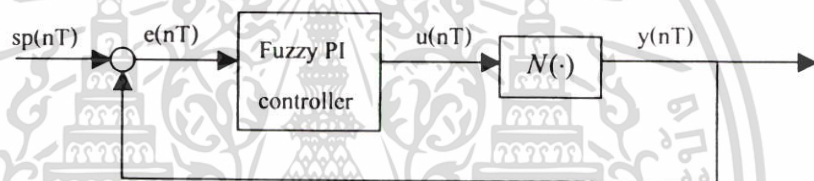
รูปที่ 3.8 ระบบการควบคุมฟัซซีพีโอแบบปิดมีกระบวนการแบบไม่เป็นเชิงเส้นแบบที่ 1
