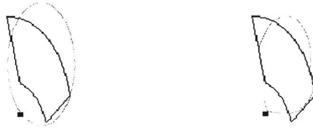
รูปที่ 4.3 สัญญาณรบกวนที่อยู่นอกวัตถุทำให้ snake ไม่สามารถเปลี่ยนรูปเข้าหาวัตถุได้
