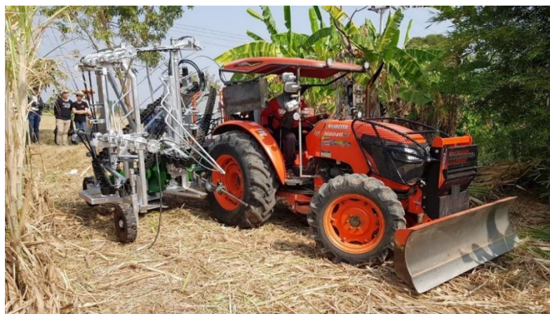
รูปที่ 5.1 แสดงการติดตั้งเครื่องเก็บเกี่ยวและสางใบต้นอ้อย
