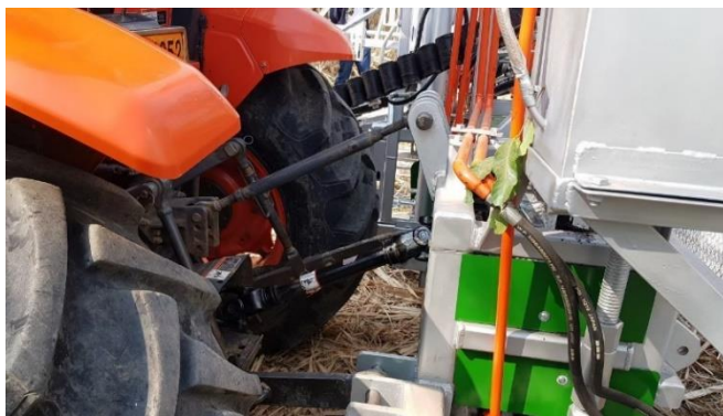
รูปที่ 4.2 แสดงการติดตั้งเครื่องเก็บเกี่ยวอ้อยเข้ากับรถแทรกเตอร์
