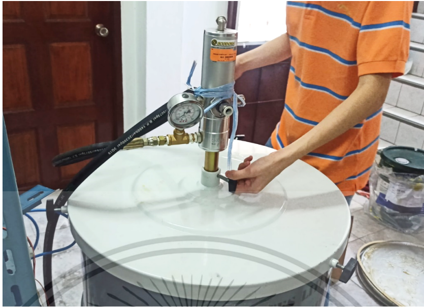
รูปที่ 4ค การใส่ตัวปั๊มจาระบี (Grease pump) ที่รูของฝาครอบถัง (Drum cover)
