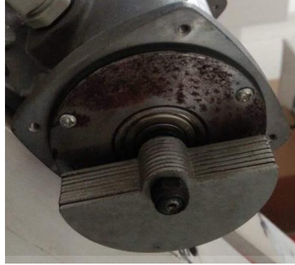
รูปที่ 3.9 มวลที่ใช้ในการทำให้เสียสมดุลขณะหมุนของมอเตอร์
