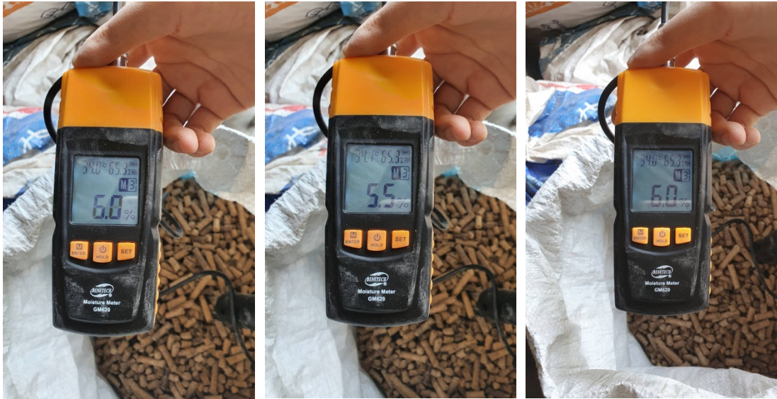
รูปที่ 5.25 แสดงค่าความชื้นของไม้ยางพาราอัดเม็ดที่วัดจากเชื้อเพลิงที่นำมาใช้ทำการทดลอง
