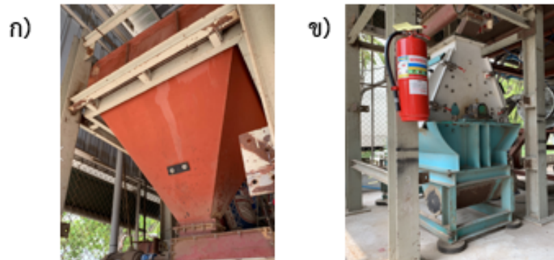
รูปที่ 4.3 แสดง ก.ไซโลเก็บเชื้อเพลิงที่ยังไม่ผ่านการบัด ข. เครื่องบัดเชื้อเพลิง [31]
