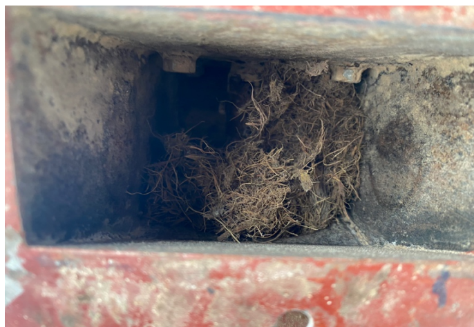
รูปที่ 5.10 เส้นใยปาล์มที่ไม่สามารถผ่านสกรูลำเลียงเชื้อเพลิงลงสู่เครื่องบดได้
