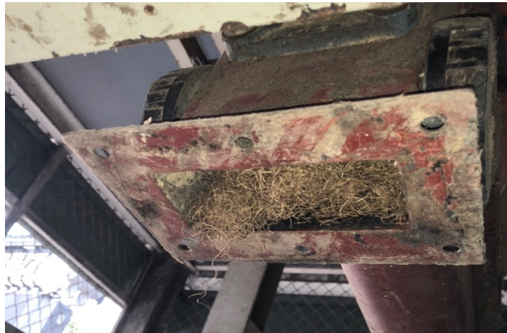
รูปที่ 5.9 ทะเลยาปาล์มที่ไม่สามารถผ่านสกรูลำเลียงเชื้อเพลิงลงสู่เครื่องบดได้
