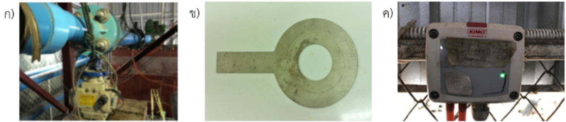
รูปที่ 4.13 แสดง ก.คอนโทรลลาลัว ข.แผ่นออริฟิส ค. Differential pressure sensor [31]
