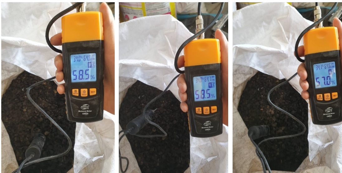
รูปที่ 5.26 แสดงค่าความชื้นของกะลาปาล์มก่อนบดที่วัดได้จากเชื้อเพลิงที่นำมาใช้ทำการทดลอง
