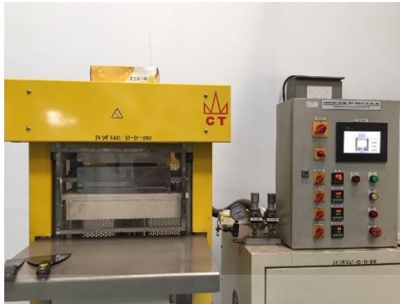
รูปที่ 2.12 เครื่องอัดขึ้นรูป
