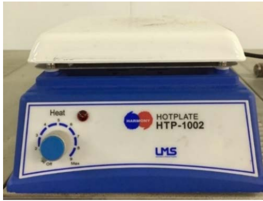
รูปที่ 2.10 เครื่องกวนสาร HOTPLATE MAGNETIC STIRRER HTP-1002
