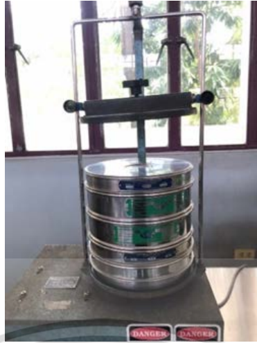
รูปที่ 3.8 คัดขนาดผักตบชวาด้วยเครื่องเขย่าคัดขนาดแบบตะแกรง (Sieve shaker)
