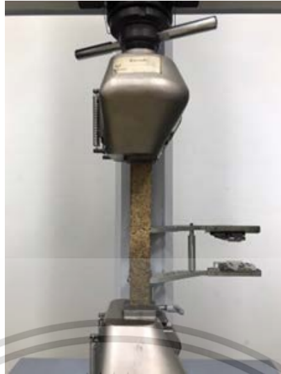
รูปที่ 3.16 การทดสอบแรงดึงด้วยเครื่องทดสอบแรงดึง
