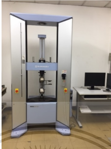
รูปที่ 2.9 เครื่องทดสอบแรงดึง AG-X Series Shimadzu Precision Universal tester
