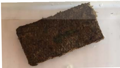
รูปที่ 3.17 การทดสอบการดูดซึมน้ำ
