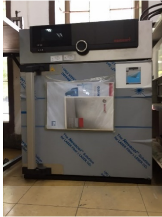
รูปที่ 2.7 ตู้บ่มร่อนยี่ห้อม MEMMERT UF110 รุ่น UN Series
