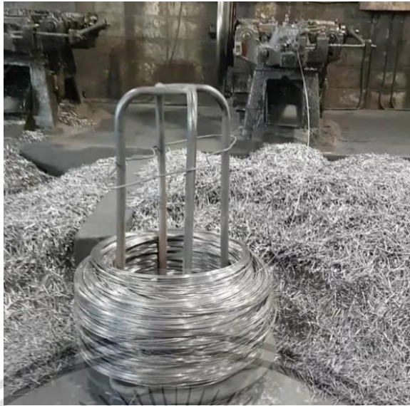
รูปที่ 3.8 กระจวยที่ถูกติดตั้งเข้ากับเครื่องตีตะปู
