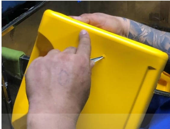
รูปที่ 4.21 พนักงานประจำเครื่องเจาะจุดดำออกจากชิ้นงาน
