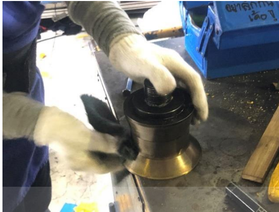
รูปที่ 4.18 พนักงานช่างทำความสะอาดพิน-ตาย
