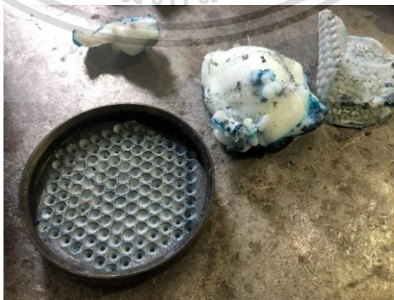
รูปที่ 3.42 ที่รองแผ่นกรองที่ทำความสะอาดแล้ว
