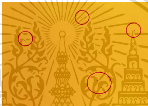
รูปที่ 3.52 ตัวอย่างจุดดำบนชิ้นงาน
