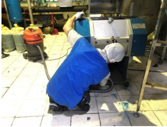
รูปที่ 3.31 พนักงานช่างทำความสะอาดภายในเครื่องบดพลาสติก
