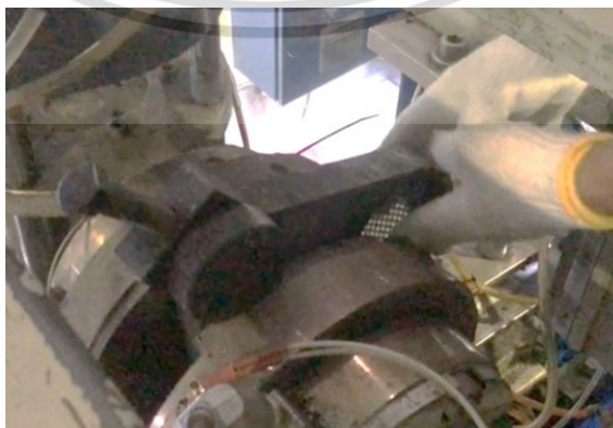
รูปที่ 3.47 พนักงานช่างประกอบที่รองแผ่นกรองเข้ากับตัวสับแผ่นกรอง
