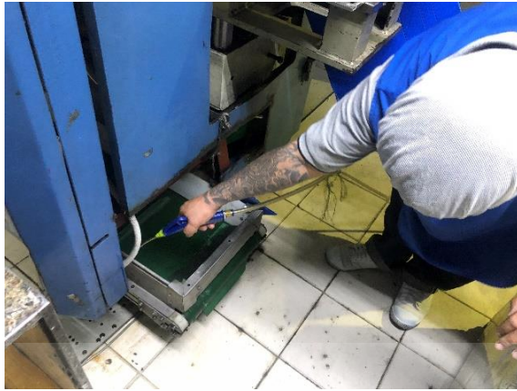
รูปที่ 4.15 พนักงานประจำเครื่องทำความสะอาดสายพานลำเลียง
