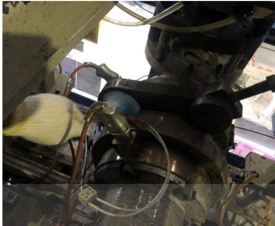
รูปที่ 3.40 พนักงานช่างทำการถอดที่รองแผ่นกรองและแผ่นตาข่ายกรองออก
