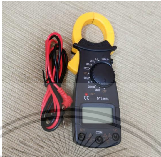
รูปที่ ผ1 Digital Clamp Meter รุ่น DT3266L
