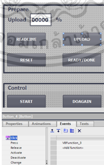
รูปที่ 3.65 การติดตั้ง Action VB Script ของปุ่ม UPLOAD
