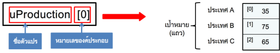
รูปที่ 2.25 ตัวแปรแต่ละตัว Array โดยใช้หมายเลขของค้ประกอบ
