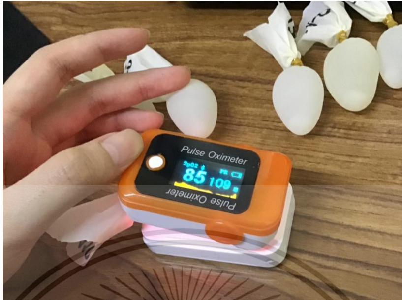
รูปที่ 3.3 แสดงการทำงานของเครื่อง Pulse Oximeter
